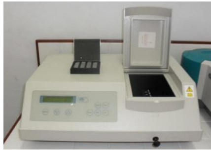
Gambar 3. Spektrofotometri UV-VIS (Sumber : Rubiyati & Setiawan, 2018 )
