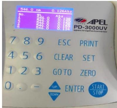
**Hasil absorbansi reagen kerja (R1) dan reagen sampel (SPL) pada alat spektrofotometer UV-Vis**
