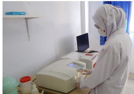
Kuvet yang berisi R1 dan SPL dimasukkan ke dalam alat spektrofotometer UV-Vis pada panjang gelombang 546 nm untuk dibaca absorbansinya.
