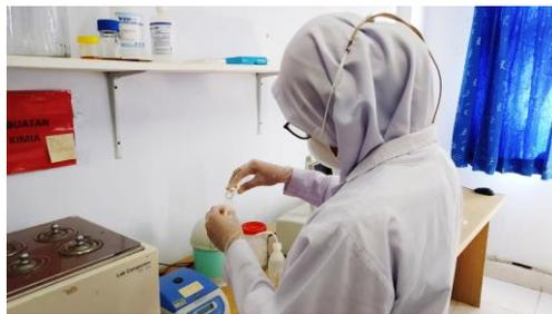
R1 (Reagen) dan SPL (Reagen Sampel) dimasukkan ke dalam kuvet untuk proses pembacaan pada alat.
