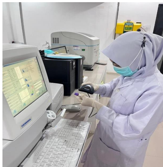
Keterangan : Proses membarkode sampel sebelum dimasukkan ke alat otomatis Hematology Analyzer ABX Pentra XL 80 .
