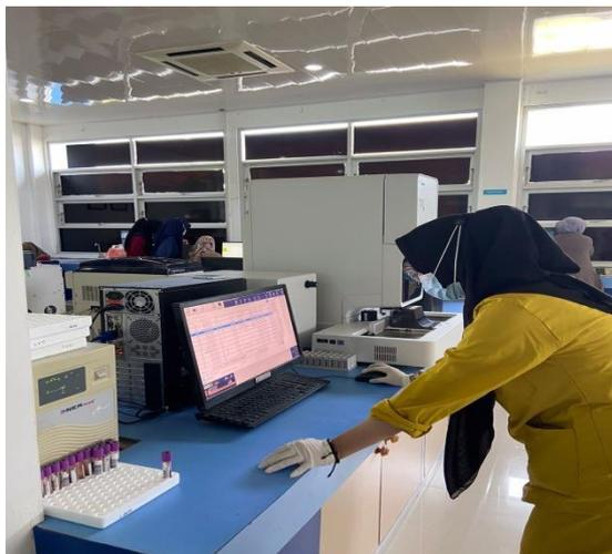
**Keterangan : proses menjalankan alat dan membaca hasil melalui komputer yang telah terhubung dengan alat Hematologi Analyzer XN-1000.**
