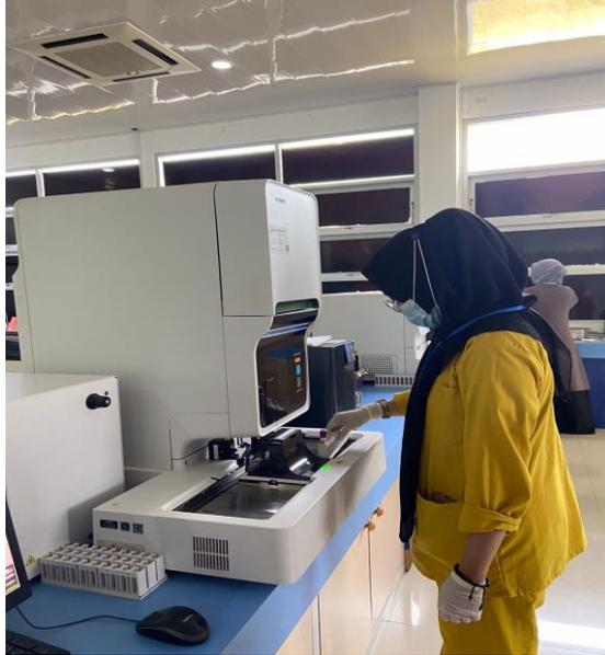
**Keterangan: Proses memasukkan sampel kedalam alat otomatis Hematologi Analyzer XN-1000.**
