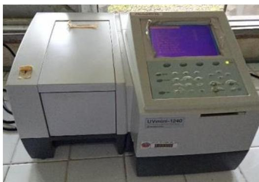
**Gambar 3.** Spektrofotometer UV-VIS
