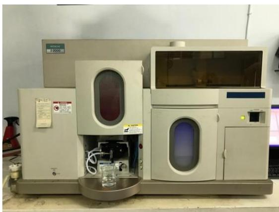
**Gambar 4.** Spektrofotometri Serapan Atom AA7000
