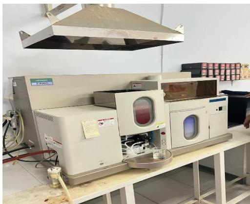
**Gambar 3.** Spektrofotometer Serapan Atom (SSA) Shimadzu AA-7000
