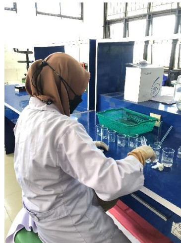
Proses melarutkan krim pemutih dengan metanol
