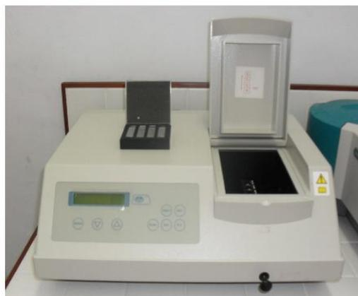
**Gambar 5.** Spektrofotometri UV-VIS
